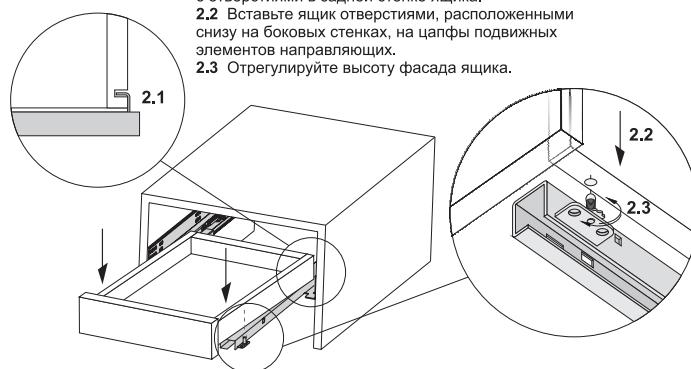
3. 3.1 Закрепите фиксаторами подвижные элементы направляющих с боковыми стенками ящика.
