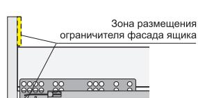
При проектировании вкладных ящиков необходимо создание опорных площадок для упора фасада (опорные площадки должны выполнять функцию боковой стенки в варианте накладного фасада). Опорные площадки предназначены обеспечивать нахождение плоскости фасада в вертикальном положении.
